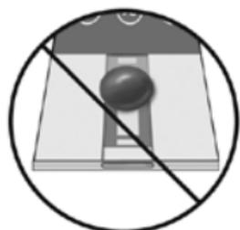
**Ne tenez pas** le lecteur et la bandelette réactive en dessous de la goutte de sang. Le sang pourrait couler dans la fente d'insertion de la bandelette réactive et endommager le lecteur.
